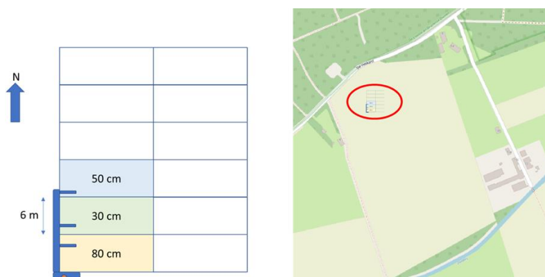
Figuur 2 Schematische weergave van de opstelling in Helvoirt. De getallen in de stroken stellen de diepwoel-diepten voor. De donkerblauwe strepen is de tracering van de kabels en de rode stip is de locatie van de dataloggers.
